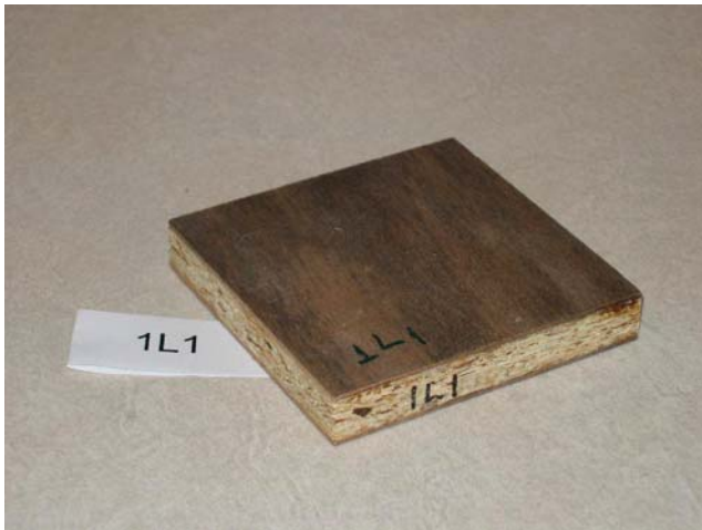
Fig. 1 Lime water treated specimen for the cone calorimeter test Abb. 1 Eine mit Kalkwasser imprägnierte Probe für die Cone-Calorimeter-Prüfung
