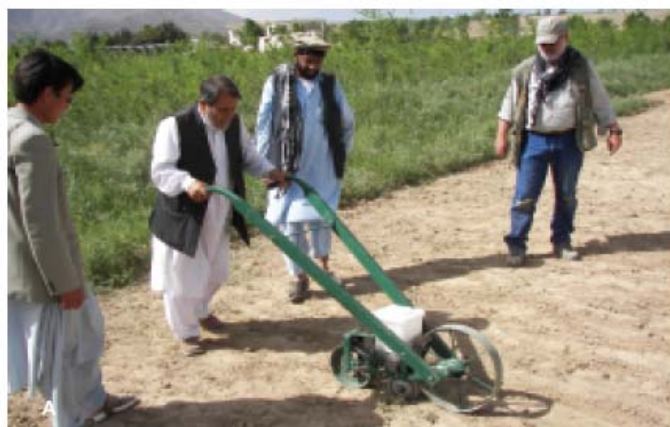
شکل 3. 6 : ( الف ) در عقب ماشین تخم پاش، پیاده رفتن، عمل تخم پاشی را تسریع می بخشد. ( ب ) چرخه راهنما (بطرف چپ) توسط پاشنه جویچه کشی تعقیب میگردد. تخم ها از قیف بالای پاشنه پائین ریخته و چرخه عقبی ( بطرف راست )، جویچه ها را می پوشاند.
