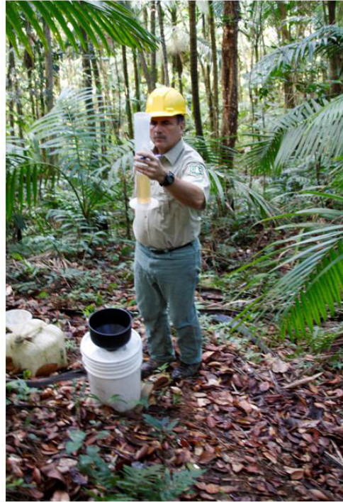
FIGURA 4. Colección de muestra de transcolación bajo el dosel del bosque, con el tercer autor midiendo la muestra en un cilindro calibrado.
