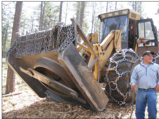
Figura 8. Una hidro-hacha es utilizada para moler árboles y reducir las cargas de combustible del dosel y por ende, los riesgos de fuegos en corona. Fotografía de Dan Binkley, Colorado State University.
