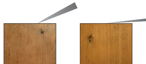
Figura 3. Ilustraciones de los ángulos de corte para maderas duras y densas, y para maderas más blandas. A la izquierda, el ángulo de la cuchilla con la madera es grande porque la madera es densa y es necesaria la cuchilla de precisión con lámina gruesa. A la derecha, el ángulo de la cuchilla es pequeño porque la madera es ligera y blanda, por lo cual es conveniente usar la delgada y afilada hojilla de afeitar.
