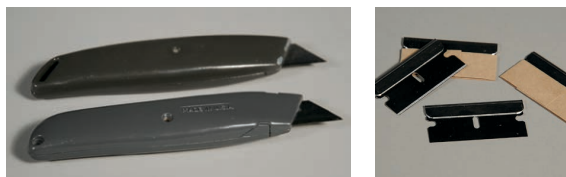
Figura 2. Dos herramientas básicas para cortar madera. Las cuchillas de precisión (foto izquierda) son las herramientas preferidas, y con éstas se harán cortes limpios de todas las maderas, excepto de las maderas más blandas. Con las hojillas de afeitar (foto derecha) se logran cortes limpios de las maderas más blandas, pero su borde es demasiado frágil para cortar maderas más densas.
