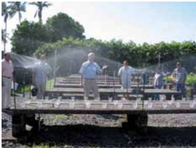
Figura 5. Verificación de la uniformidad de la distribución del agua de un sistema de riego aplicando el “test de copas” (o de vasos). Los vasos se distribuyen de manera regular en un patrón cuadrículado encima del área de cultivo. Una vez aplicado un riego se verifica la profundidad del agua que debe ser la misma en todos los vasos (Foto: Kim M. Wilkinson).
