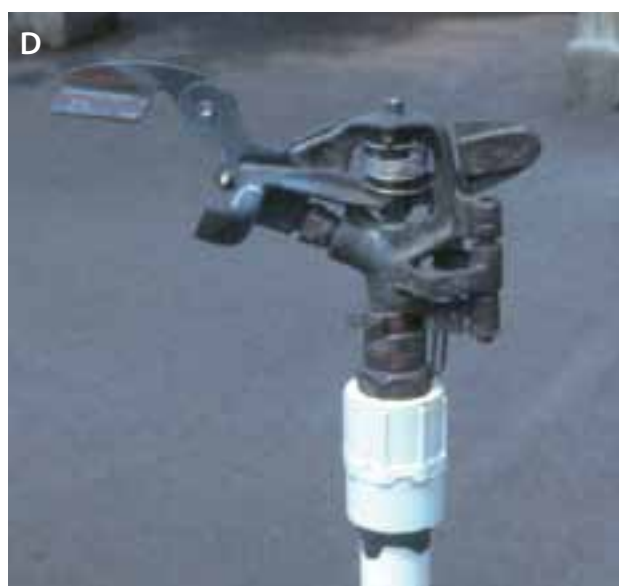
Figura 2. Sistema de riego fijo suspendido con aspersores rotatorios (A) o emisores fijos (B), estos últimos pueden cubrir círculos completos, de un cuarto, media, o tres cuartas partes de una circunferencia (C). Sistema de riego fijo basal con aspersor de impacto rotatorio (D); por su largo alcance este sistema suele utilizarse en cultivos a la intemperie (Fotos: Thomas D. Landis).
