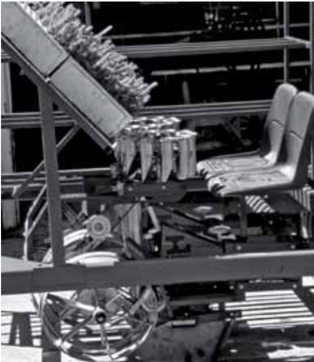
Figura 2. Trasplantadora de tipo rotatoria desarrollada especialmente para plantar miniplugs.
