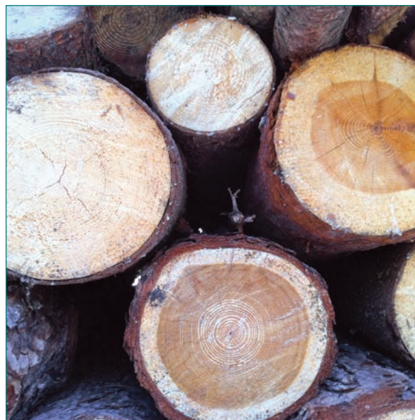
FIGURA 1 - Sezioni trasversali di fusti legnosi di diverse specie di conifere. In tutti i fusti sono visibili la corteccia e il legno, nei fusti di alcune specie è distinguibile il durame grazie al suo colore diverso rispetto all'alburno.
