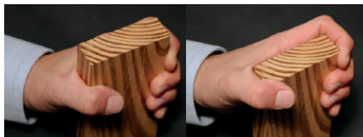
Figura 5. Manipulación correcta de un espécimen para su corte (izquierda). Nótese que los dedos y el pulgar están debajo del borde superior del espécimen y no serán cortados. A la derecha el espécimen es agarrado con los dedos y el pulgar de tal manera que nos lesionaremos al realizar el corte.
