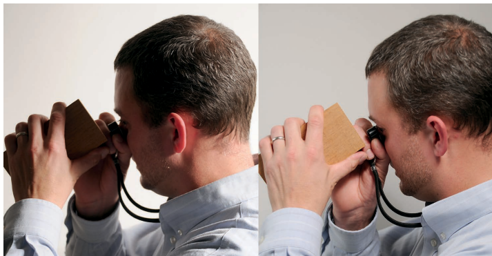
Figura 3. En la imagen a la izquierda, la cabeza del observador está bloqueando la luz y el espécimen no puede ser observado apropiadamente. En la imagen a la derecha, el observador está permitiendo que la luz caiga sobre el espécimen para asegurar una observación correcta.
