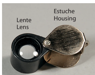
Figura 1. Una lupa de mano tiene dos partes principales, la lente y el estuche.
