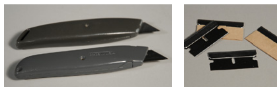
Figura 2. Dos herramientas básicas para cortar la madera. Las cuchillas de precisión o cúteres (fotografía izquierda) son la mejor herramienta para cortar la madera y permite hacer cortes limpios de todas las maderas, excepto en las muy blandas. Las hojillas de afeitador (fotografía derecha) producen cortes limpios en las maderas más blandas, pero su borde es demasiado frágil para permitir cortar maderas más densas.
