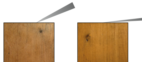
Figura 3. Ilustraciones que muestran los ángulos de corte para maderas duras y densas y para maderas más blandas y ligeras. A la izquierda, el ángulo de la cuchilla con la madera es mayor porque la madera es densa y necesita la lámina gruesa del cúter. A la derecha, el ángulo de la cuchilla con la madera es menor porque la madera es ligera y blanda, por lo cual es más conveniente utilizar una hojilla de afeitador, que es más fina y afilada.
