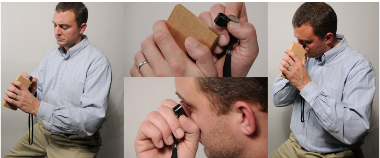
Figura 2. El uso de una lupa de mano para observar una muestra de madera. A la izquierda, la fotografía muestra que la distancia entre el lente y el ojo del observador es demasiado grande, pero la distancia entre el lente y la muestra de madera es la correcta. La fotografía superior central muestra la distancia correcta entre el lente y la muestra de madera. La fotografía inferior central muestra la distancia correcta entre la lente y el ojo. La fotografía de la derecha muestra las distancias correctas entre el lente, la muestra y el ojo.
