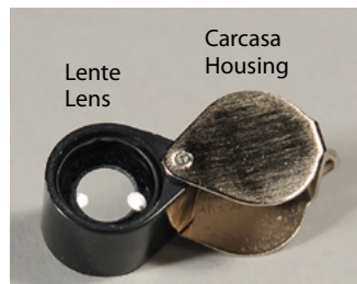
Figura 1. Una lupa de mano tiene dos partes principales, un lente y la carcasa que lo cubre.
